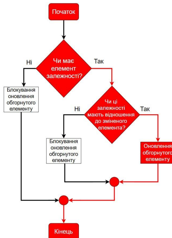
Рис.2.12. Узагальнена схема алгоритму прийняття рішення НОС про перемальовування елемента: випадок 2
