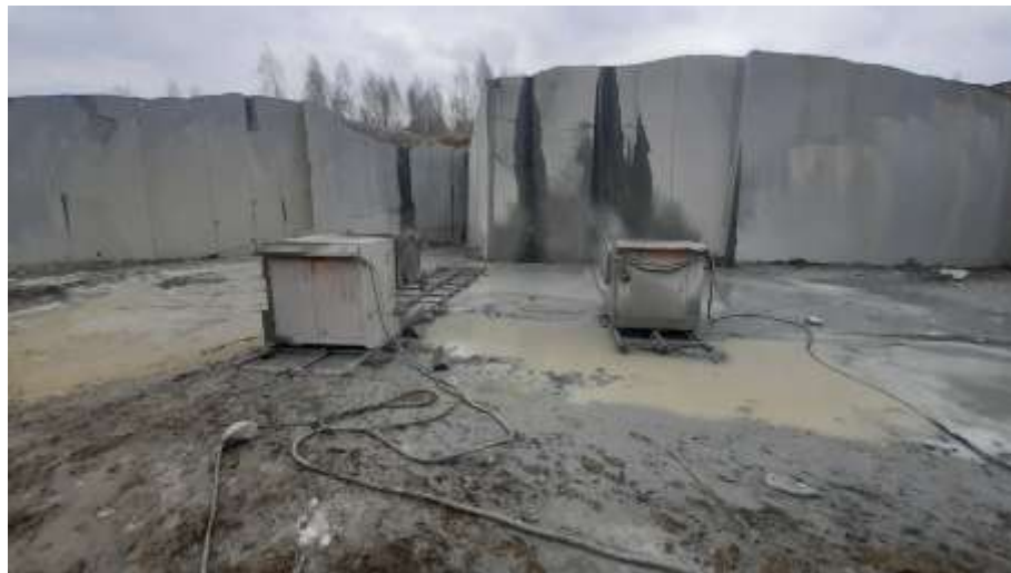
Рис. 1.6. Формування моноліту природного облицювального каменю методом алмазно-канатного різання
