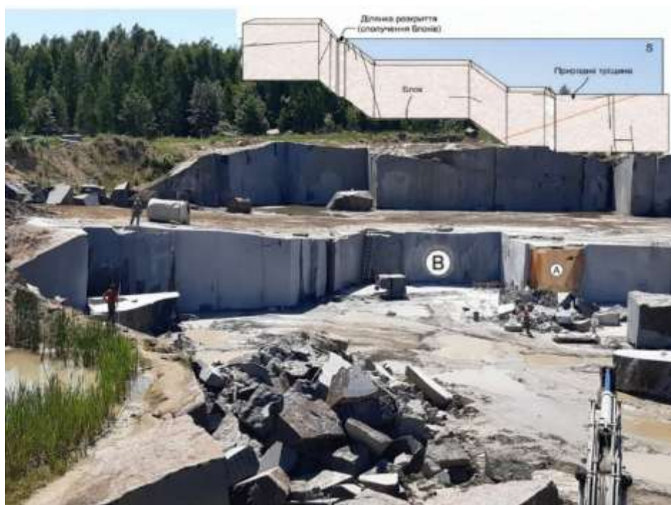
Рис. 1.1. Схема тріщинуватості та природної блочності гірського масиву
