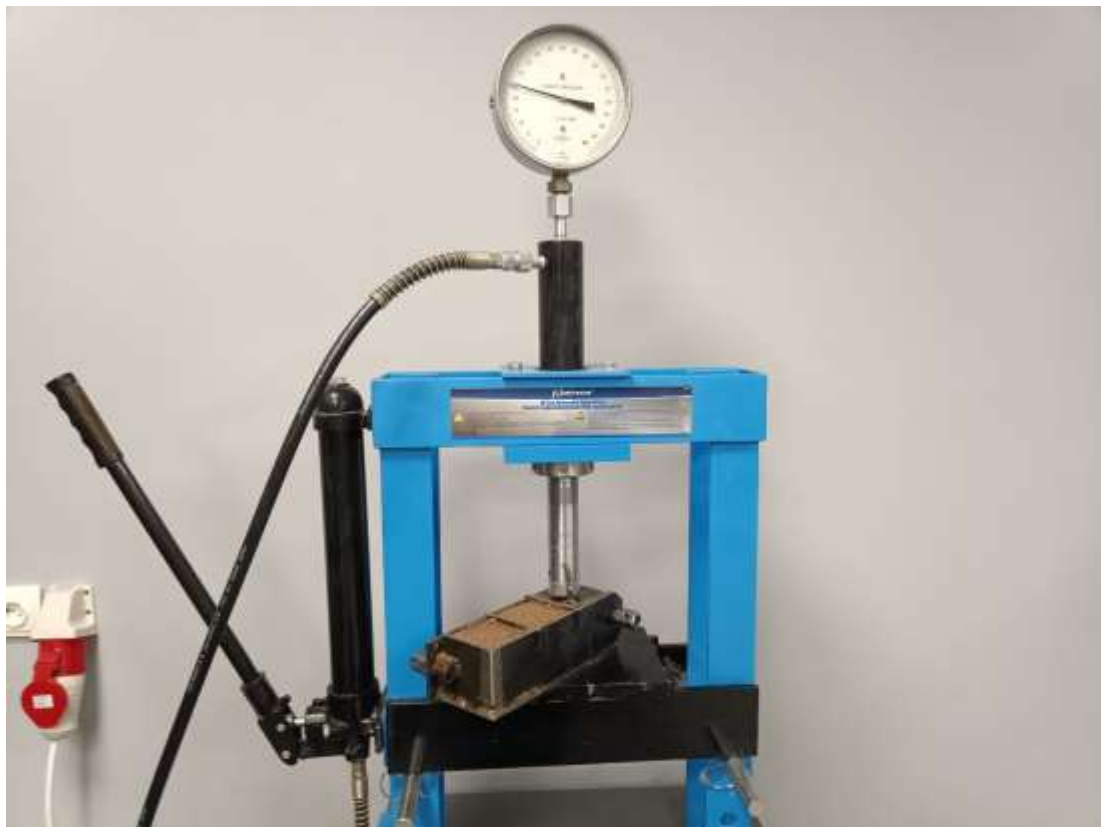
Рис. 2.11. Процес напівсухого пресування ручним пресом UTEST (макс. зусилля 10 т)
