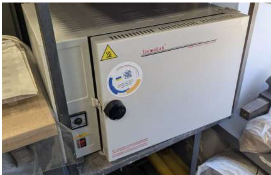
Рис. 2.8. Лабораторна сушильна шафа TermoLab, використана для підготовки сировинних матеріалів
