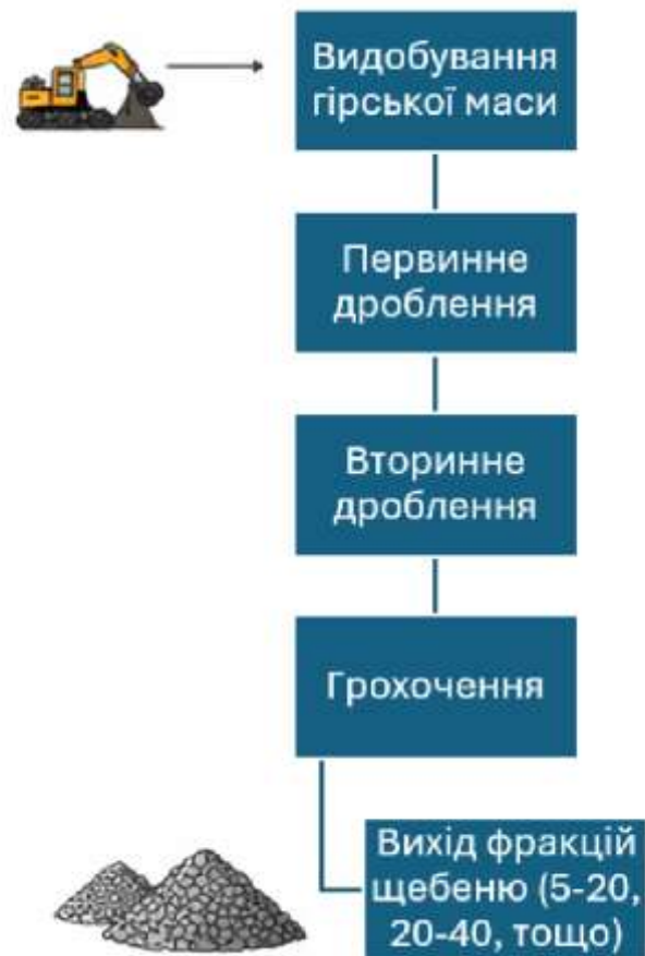
Рис. 1.5. Технологічна схема утворення відсівів у процесі виробництва щебеню
