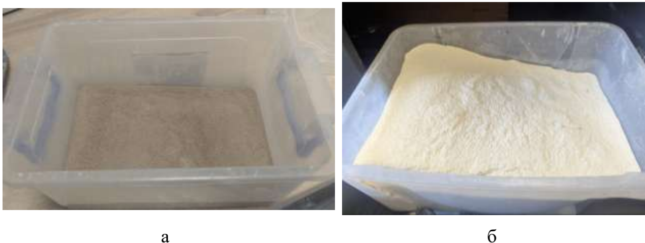
Рис. 2.10. Просіяні компоненти формувальної маси: а – відсів гранітного щебеню; б – каолін
