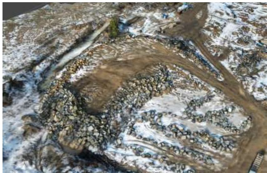
Рис. 2.3. Тривимірна фотограмметрична модель відвалу Шадурського родовища габро
