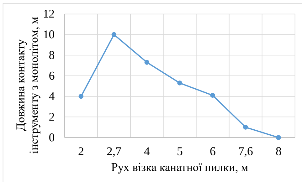
Рис. 4.2. Залежність зміни довжини контакту інструмента з породою (тобто довжини лінії різку) від переміщення візка канатної пилки
