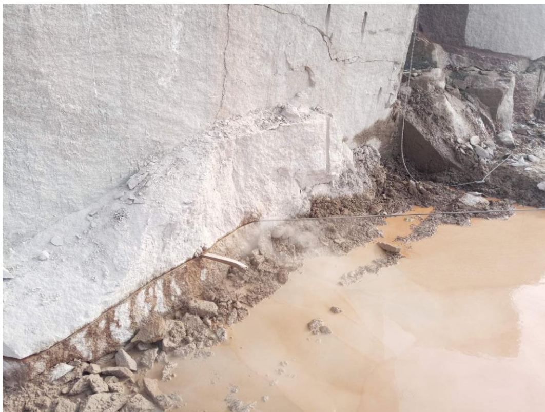
Рис. 3.2. Вигляд сходинки під час підрізання моноліту алмазно-канатною пилкою
