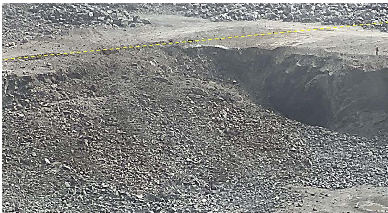
Рис. 3.3. Орієнтація підривних блоків відносно розломів у кар'єрі
