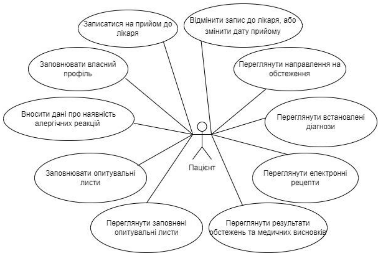
Рис. 3.1. Діаграма прецедентів пацієнта по роботі в системі
