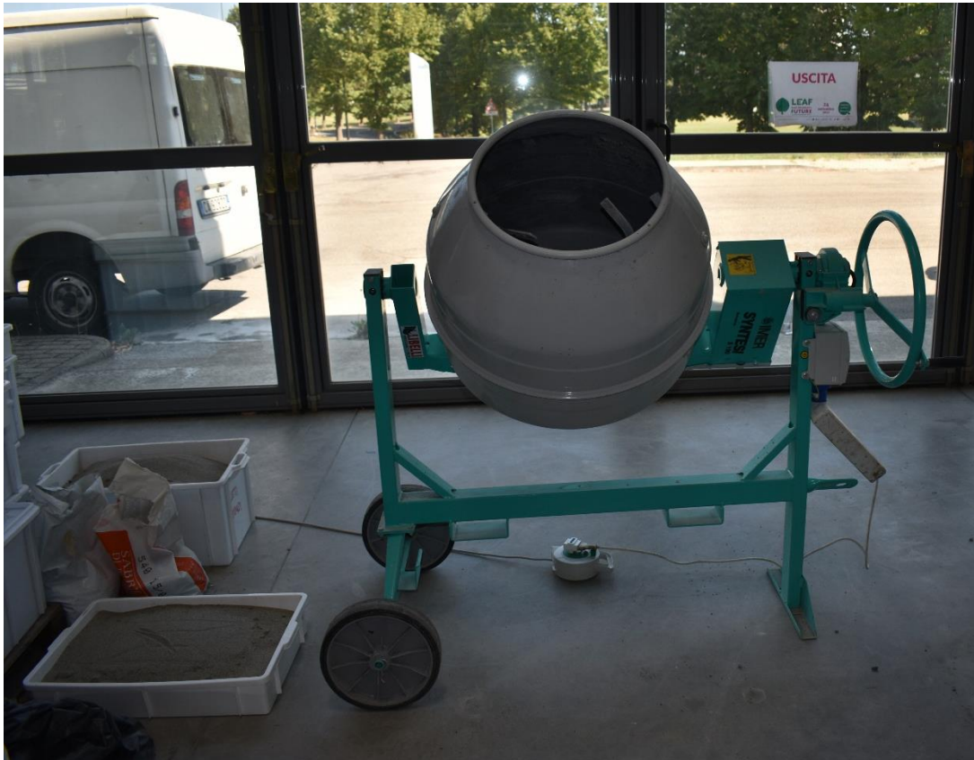
Рис 3.2. Лабораторний змішувач барабанного типу
