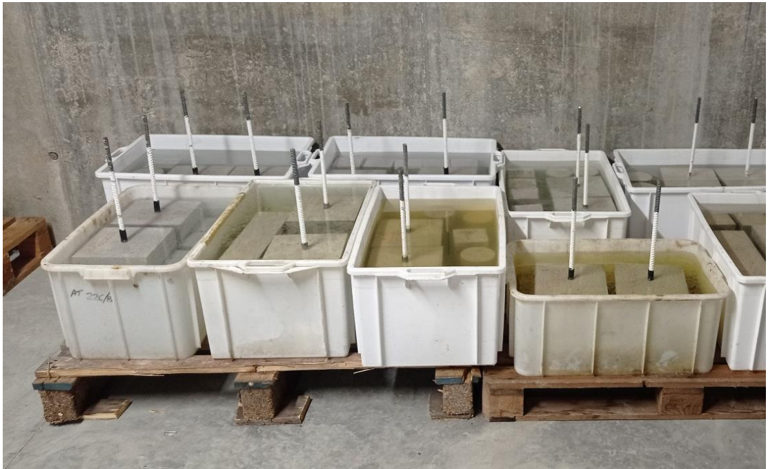
Рис 3.4. Етапи затвердіння бетону: зразки занурені в воду для гідротермічного визрівання перед випробуваннями на міцність
