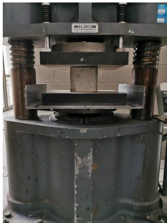
Рис 2.7. Випробування на стиск
