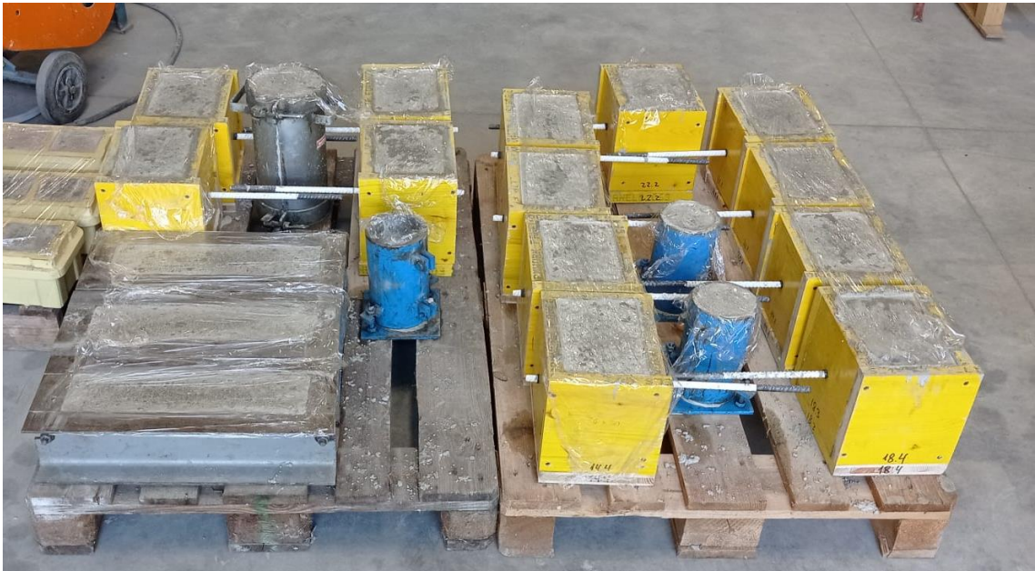
Рис. 3.3. Зразки бетону в стандартних формах, загорнуті та марковані для подальших випробувань
