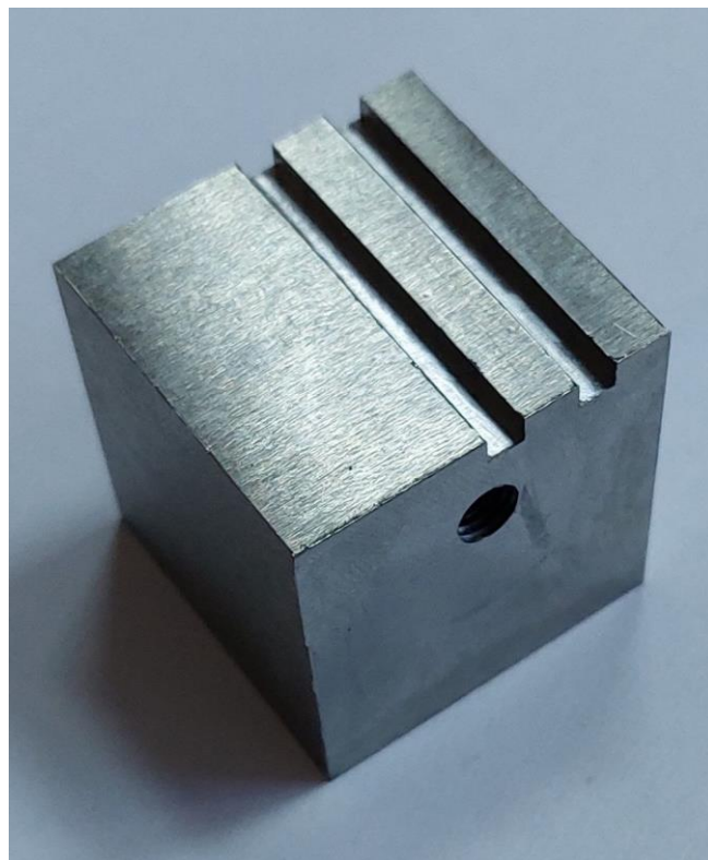
Рис. 2.2 – Заготовка із сплаву NiTi для досліджень з визначення вібраційних сигналів під час мікрофрезерування
