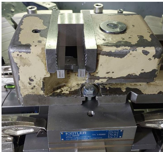
Рис. 2.13 – Механічне закріплення заготовки на вимірювальний блок динамометру KISTLER 9257B
