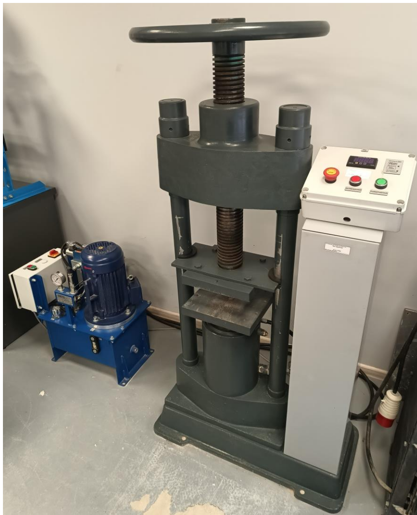
Рисунок 2.2 – Модернізований гідравлічний прес П-50
