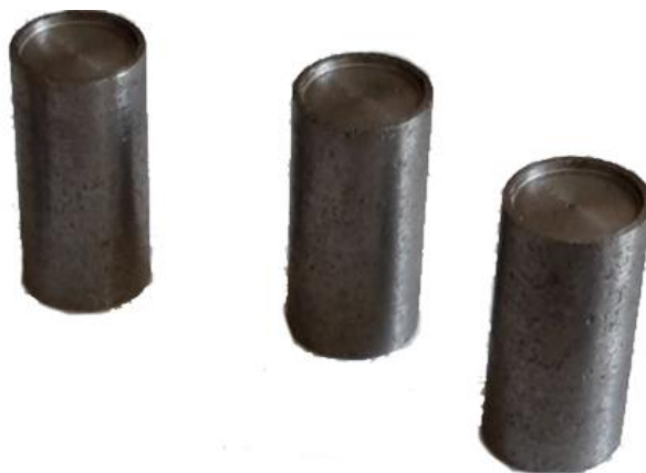
Рисунок 2.7 – Зразки для проведення випробувань на стиснення
