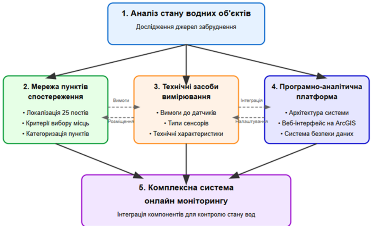
Рис. 6. Структурно-функціональна модель комплексної системи онлайн-моніторингу поверхневих водних об'єктів (розроблено автором)
