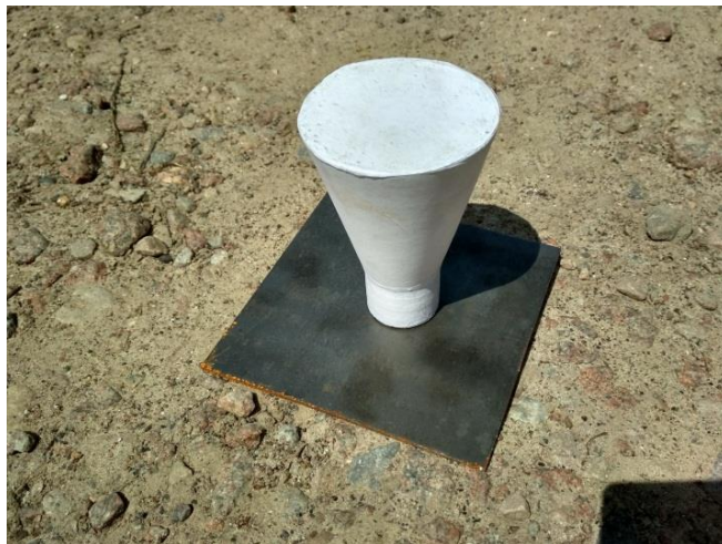
Рис. 10. Конічний проміжний детонатор (бойовик) на 5-тиміліметровій сталевій пластині-свідку
