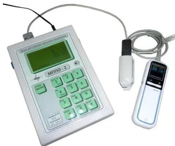
Рис.4.11. Міра для перевірки пульсових оксиметрів МППО-2
