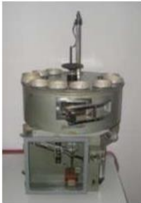
Рис. 3.4 Електрична напіваавтоматична сушильна шафа Брабендера
