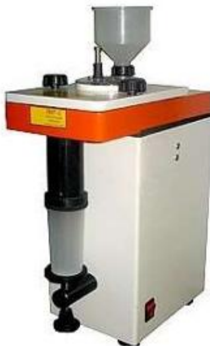
Рис. 3.3 Лабораторний млин ЛМТ-2
