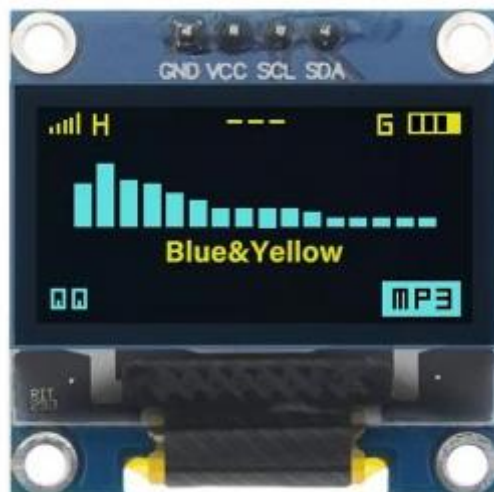
Рис.4.6. Дисплей OLED-дисплей SSD1306
