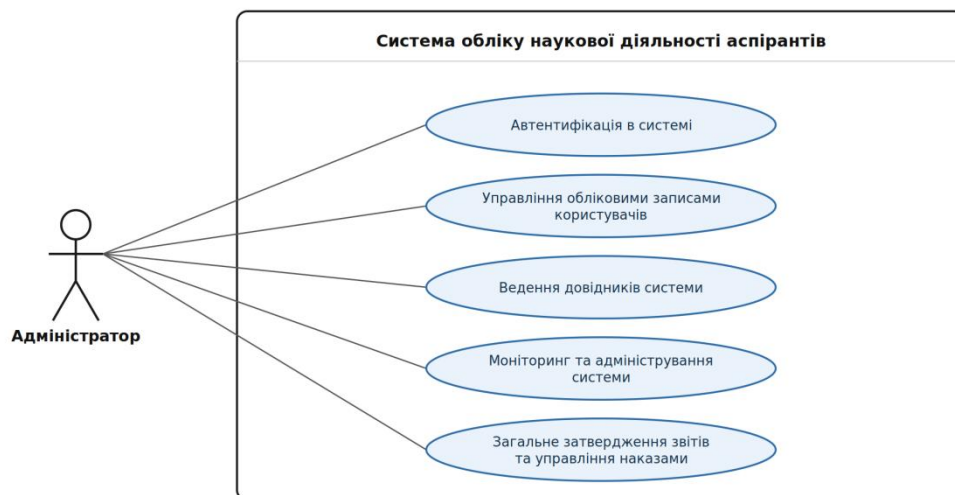
Рис. 2.4. Діаграма варіантів використання для актора «Адміністратор»
