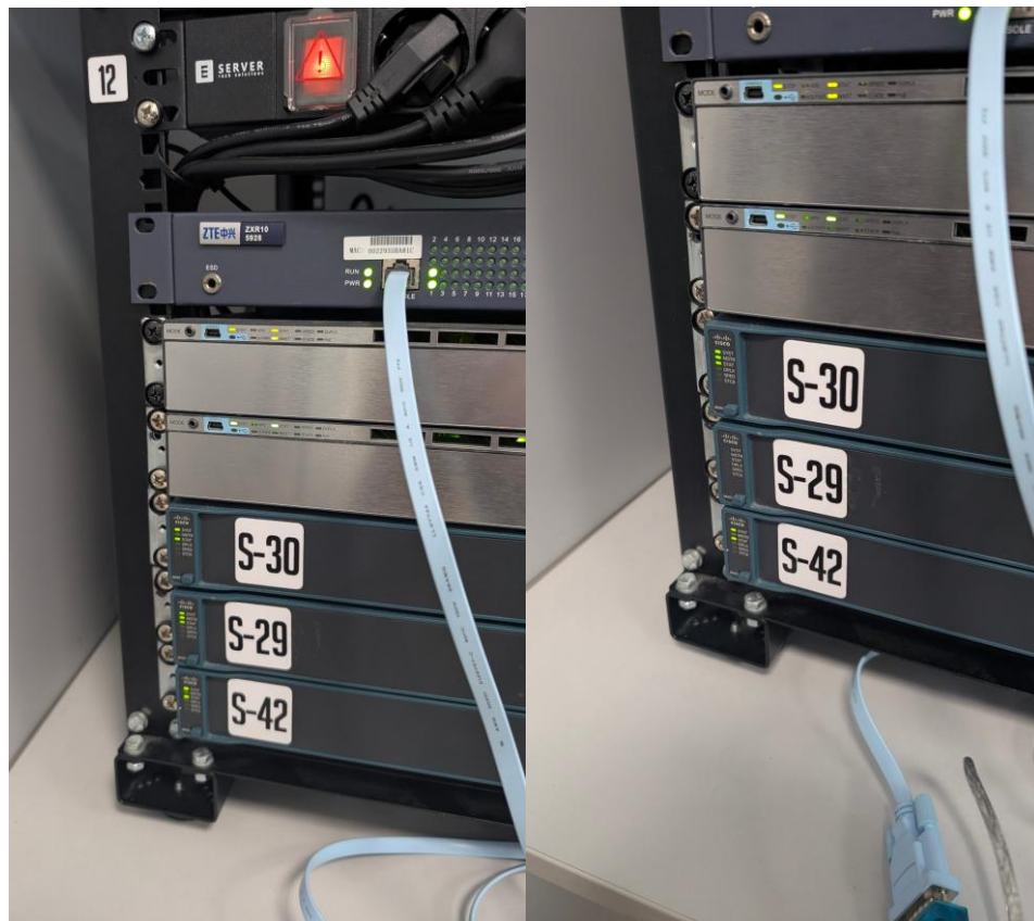
Рисунок 3.22 – Зміна складу стеку та його автоматичне відновлення
