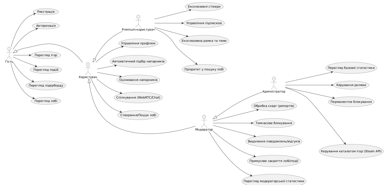
Рисунок 2.6 – Діаграма взаємодії варіантів використання для різних ролей
