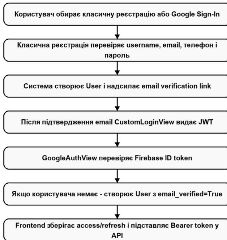
Рис. 2.6 – Схема процесу реєстрації та автентифікації користувачів
