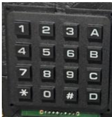
Рисунок 2.10 – Матрична клавіатура 4x4
