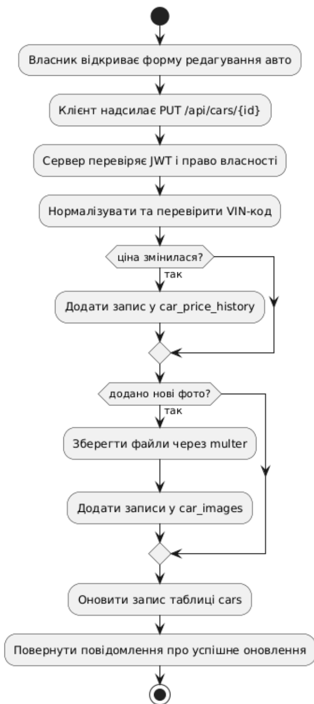
Рисунок 2.10 Алгоритм редагування автомобіля та фіксації зміни ціни
