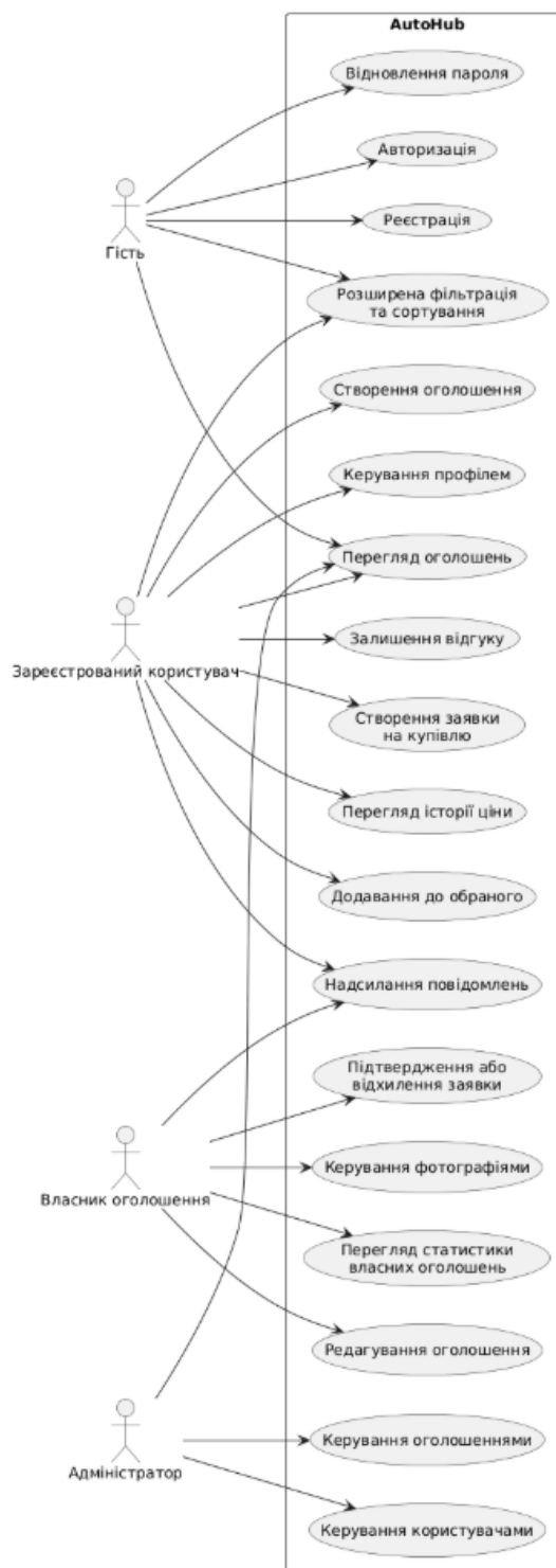
Рисунок 2.1 – Діаграма варіантів використання веб-застосунку продажу вживаних автомобілів
