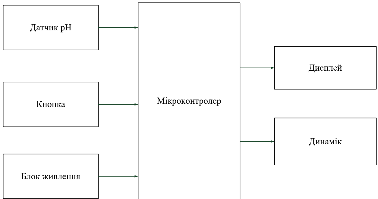
Рис.3.1 Структурна схема системи
