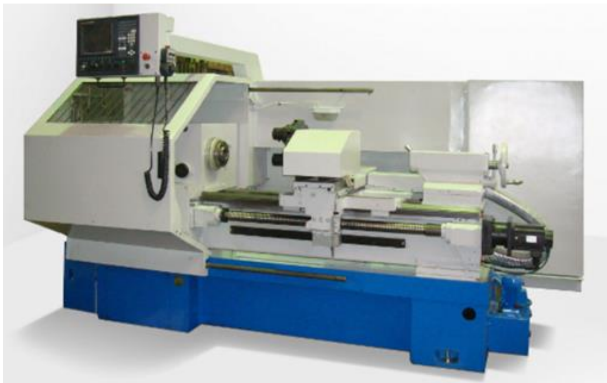
Рис. 2.4. - Токарний верстат з ЧПУ моделі 16K20T1
