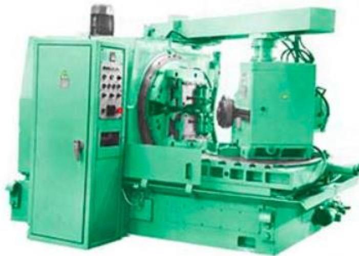
Рис. 2.7. Зубострогальний верстат 5С276П
