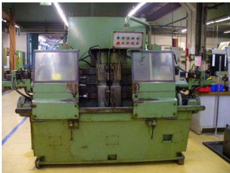
Рис. 2.3. - фрезерно-центрувальний верстат МР 71-М
