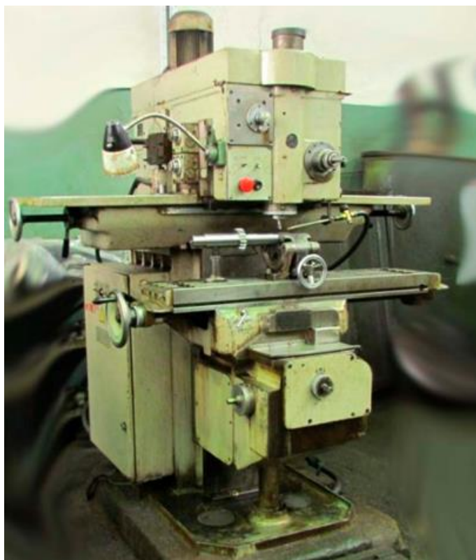
Рис. 2.6. Верстат шпонково-фрезерний вертикальний 692Р
