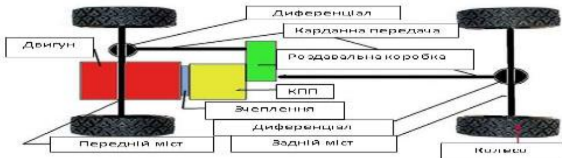
Рисунок 1.7 – Трансмісія повнопривідного автомобіля
