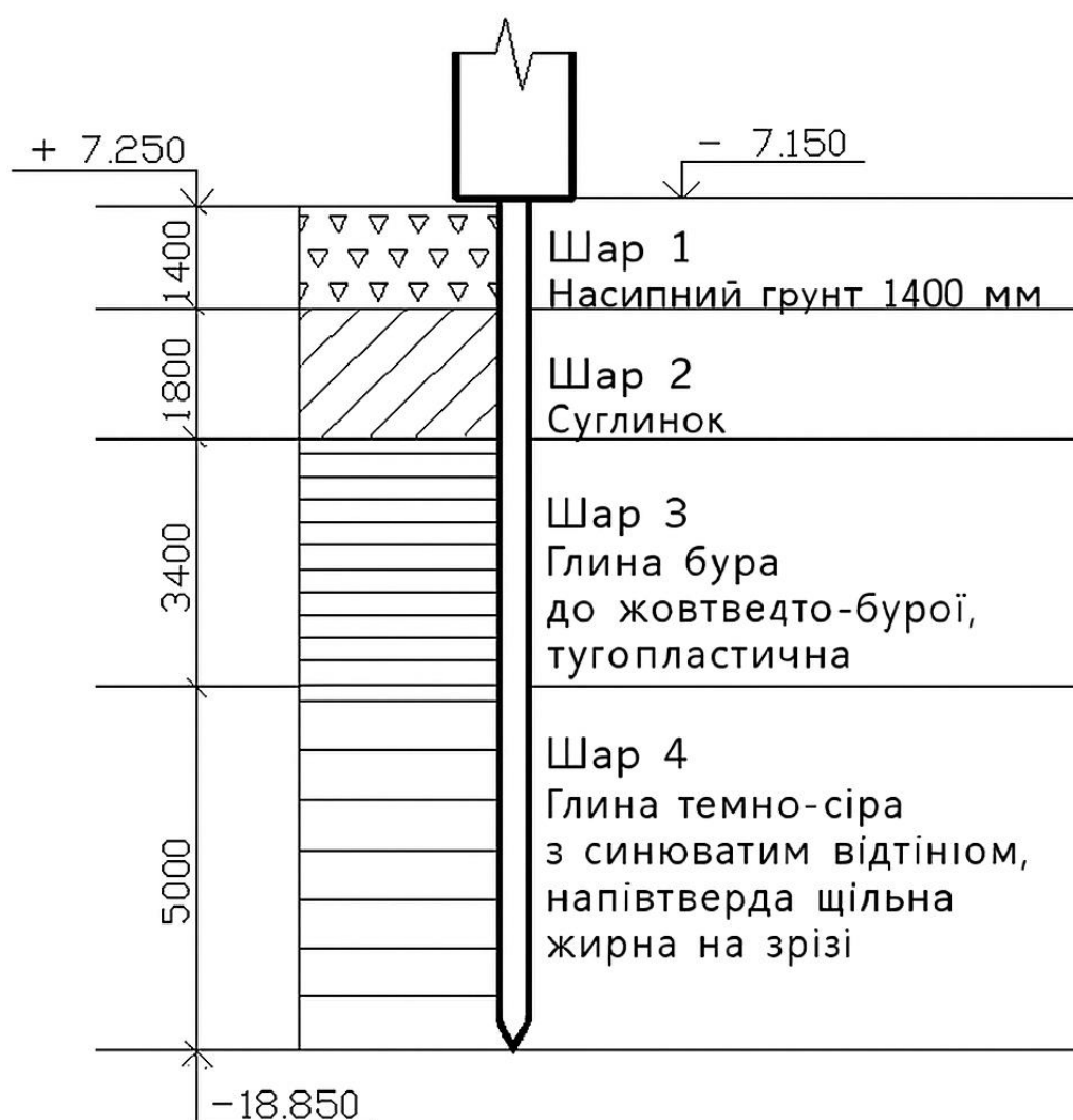
Рис.3.1. Інженерно-геологічні умови будівельного майданчика
