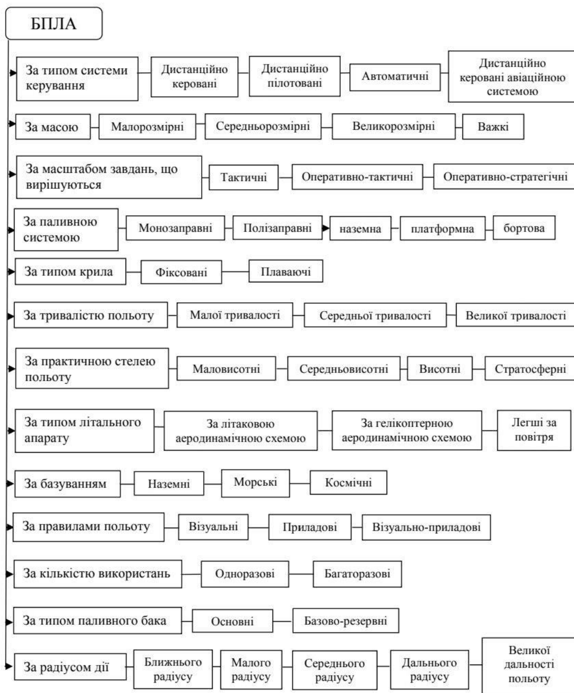
Рисунок 1.1 – Класифікація безпілотних літальних апаратів
