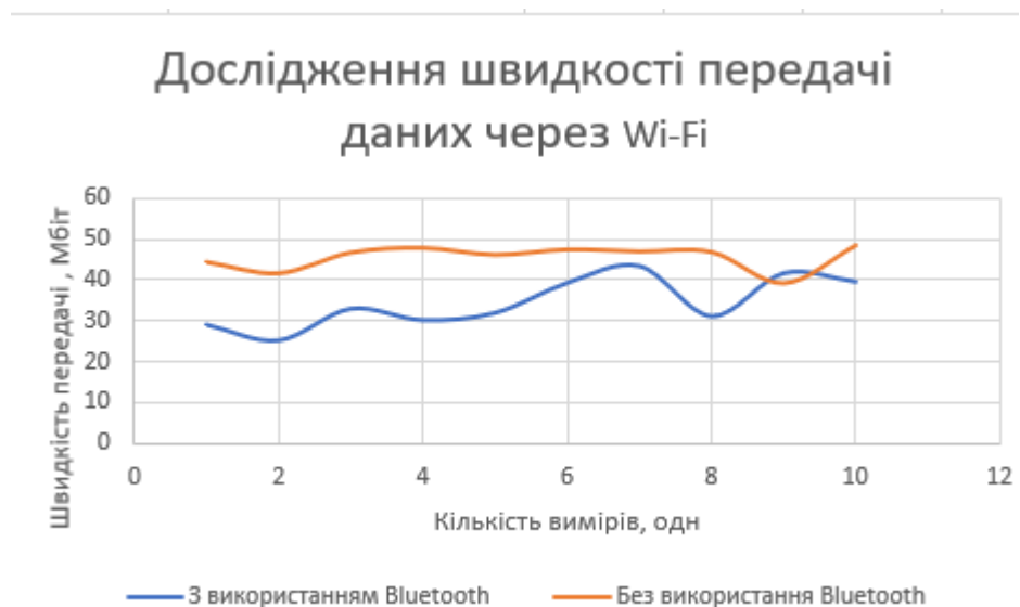
Рисунок 3.2 – Залежність швидкості Wi-Fi від Bluetooth
