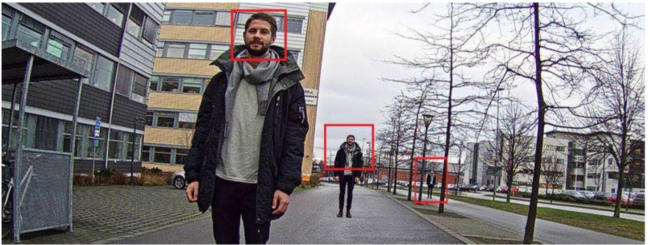
Рисунок 3.4– Робота відеокамери з розпізнаванням обличчів на різних дистанціях
