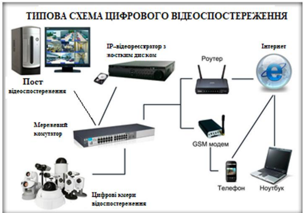
Рисунок 1.5 – Схема цифрової системи відеоспостереження
