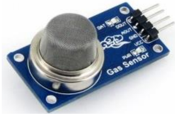
Рисунок 2.7 – Друкована плата з датчиком «MQ-135»
