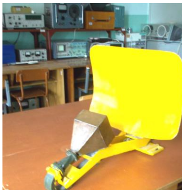
Рис. 3.1 Рупорний опромінювач зі зменшеним перевипромінюванням від кромки
