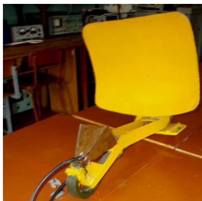
Рис. 3.2 Рупорний опромінювач зі щілинним відведенням основної моди для зменшення перевипромінювання від апертури
