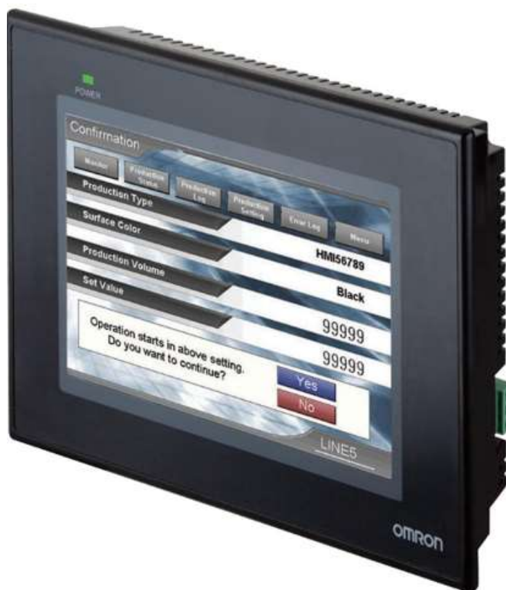
Рис. 3.8 Панель Керування 24В DC NB10-TW001
