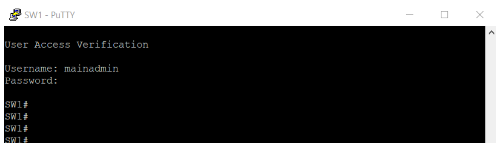
Рисунок 3.33 – Перевірка аутентифікації на комутаторі
