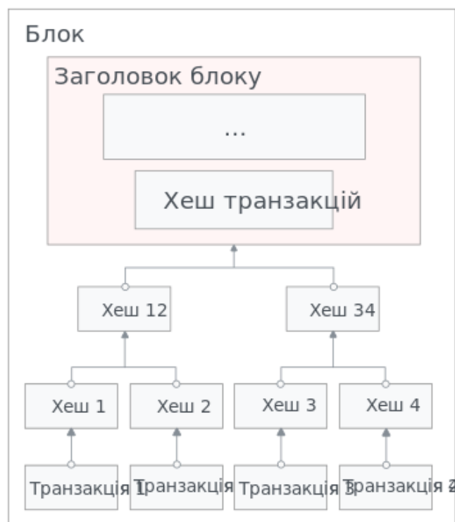
Рисунок 1.1 – Схема блоку транзакцій
