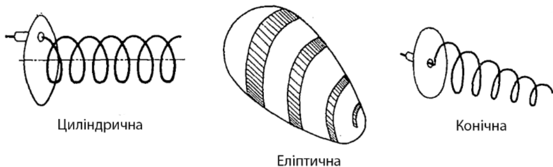
Рисунок 1.2 – Приклади спіральних антен за особливостями конструктивного виконання.
