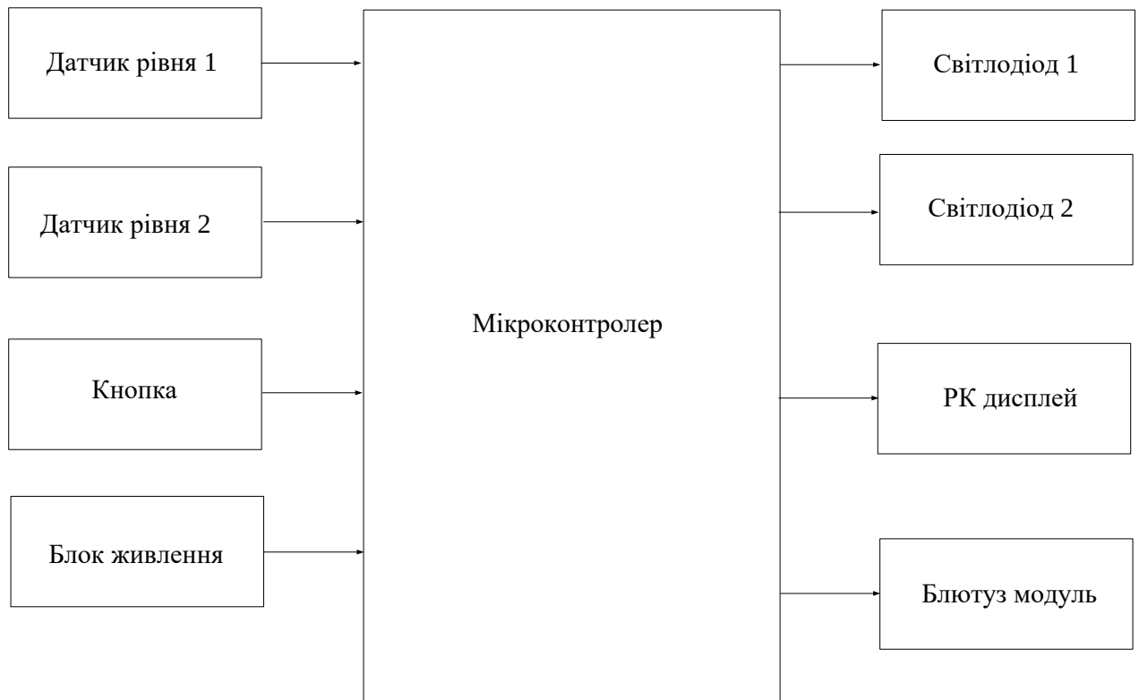
Рис. 3.15 - Структурна схема вимірювальної системи
