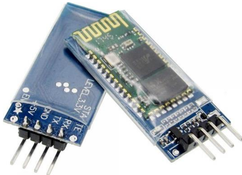
Рис.3.7. Bluetooth модуль HC-06
