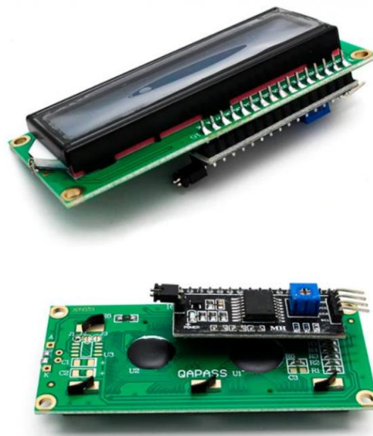
Рис. 2.3. Дисплей LCD 1602 з модулем I2C
