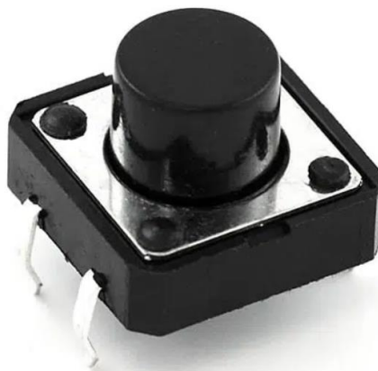
Рис. 4.4 – Тактова кнопка TS7701-5.0-250
