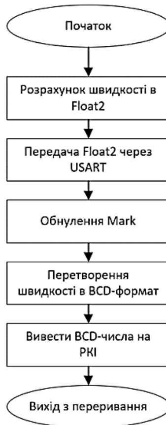
Рис. 4.10. Блок-схема алгоритму обробки переривань таймеру
