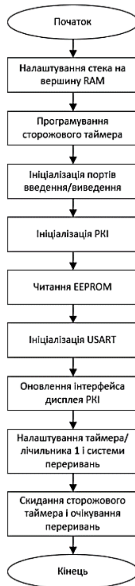
Рис. 4.7. Блок-схема алгоритму основної програми
