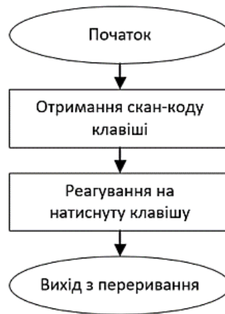
Рис. 4.9. Блок-схема алгоритму обробки переривань INT0
