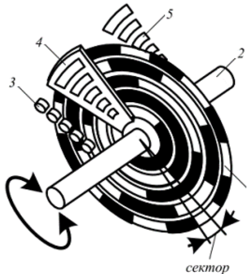
Рис. 1.7 Схема абсолютного энкодера
