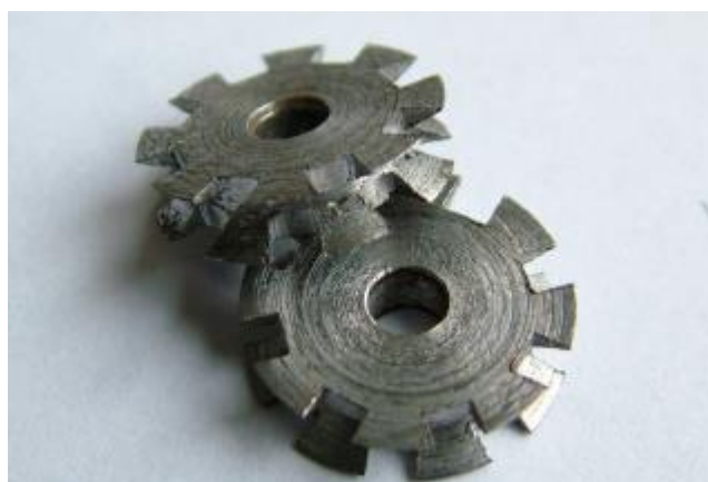
Рис. 1.4. Профільні ролики для накочування замкового профілю
