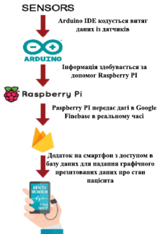
Рисунок 3.7 – Архітектура блоків модулів віддаленої системи моніторингу
