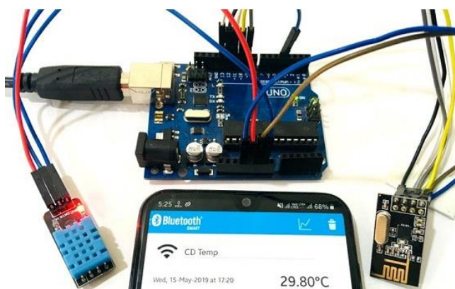
Рисунок 3.2 – Приклад – передача даних температури з датчика DHT11 на смартфон за допомогою модуля Arduino и nRF через BLE.
