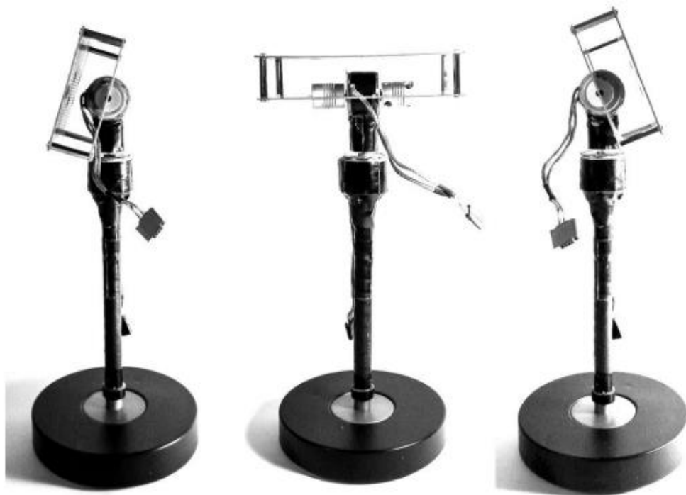
Рис 1.7. Збірка апаратного забезпечення TTDAT з його положеннями максимального вторинного обертання.
