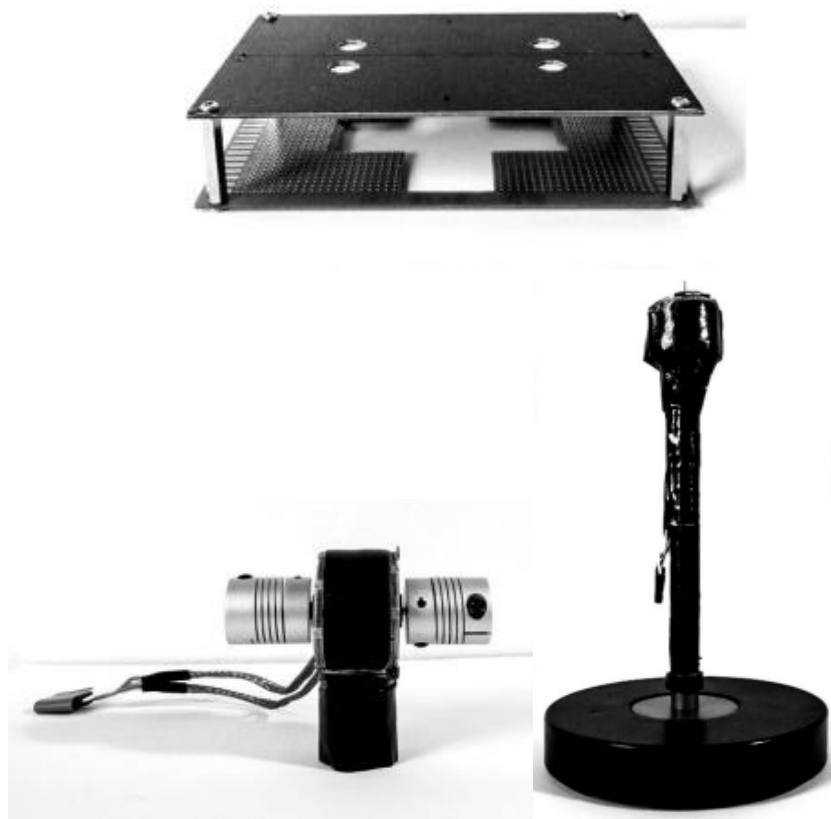
Рис.1.6. Остаточна конструкція механічних частин системи TTDAT (кріплення для сонячної, двигун с муфтами , основа для полярного кріплення з приєднаним основним двигуном)
