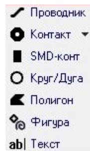
Рис.3.10. Інструменти для створення доріжок, контактів, фігур у програмі Sprin-Layout
