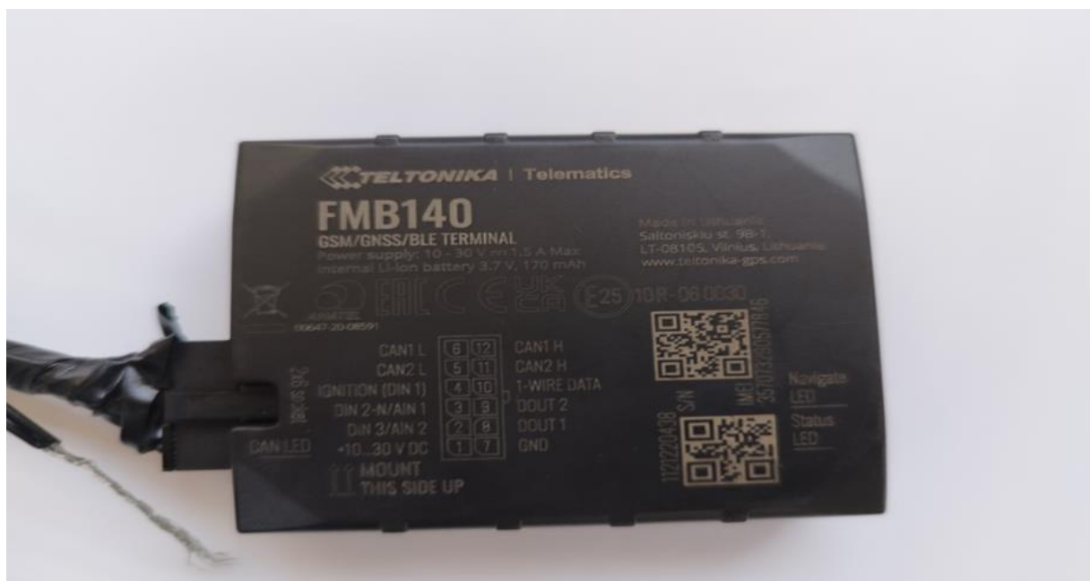
Рис 3.4 Трекер з вбудованим CAN модулем Teltonika FMB 140
