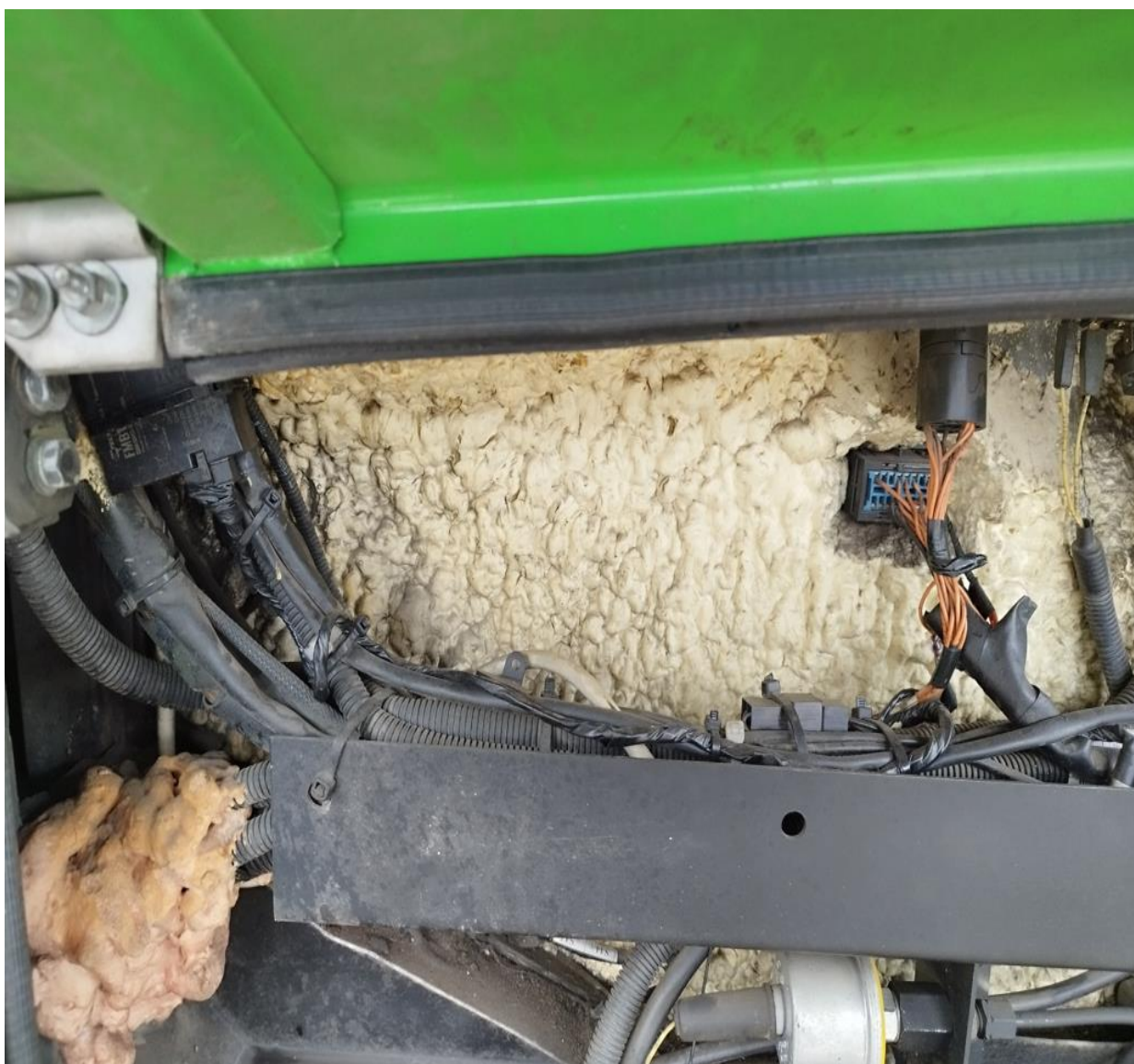
Рис 3.8 Змонтований трекер з підключенням до CAN шини
