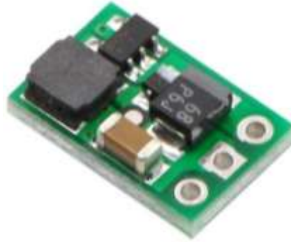
Рис. 3.7. Вигляд підвищуючого перетворювача NCP1402
