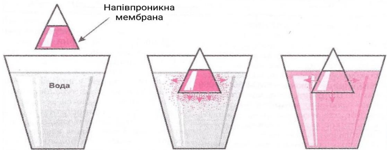
Рисунок 1.1 – Принцип дифузії розчинених речовин через напівпроникну мембрану
