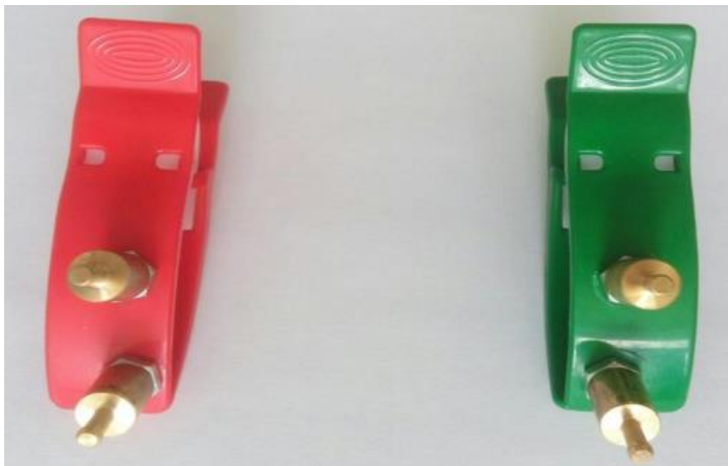
Рисунок 3.1 – Розроблені електроди, для діагностики та візуалізації тканини серця людини
