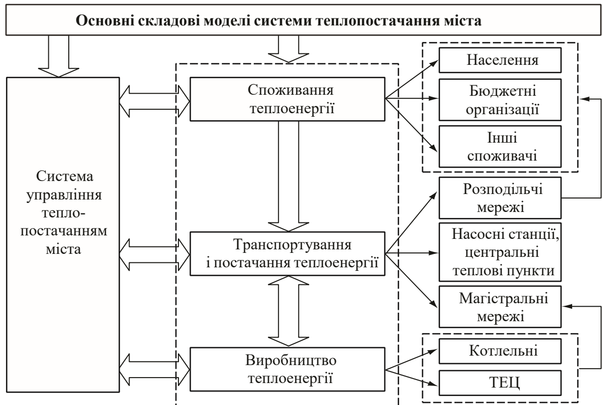
Рис. 1.4. Модель централізованого теплопостачання
