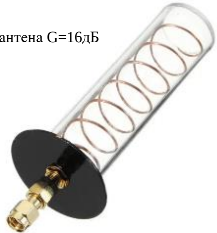
Рисунок 1.6 – Патч та спіральна антени для FPV на 5.8 ГГц з коефіцієнтами підсилення 8 дБ та 16 дБ відповідно
