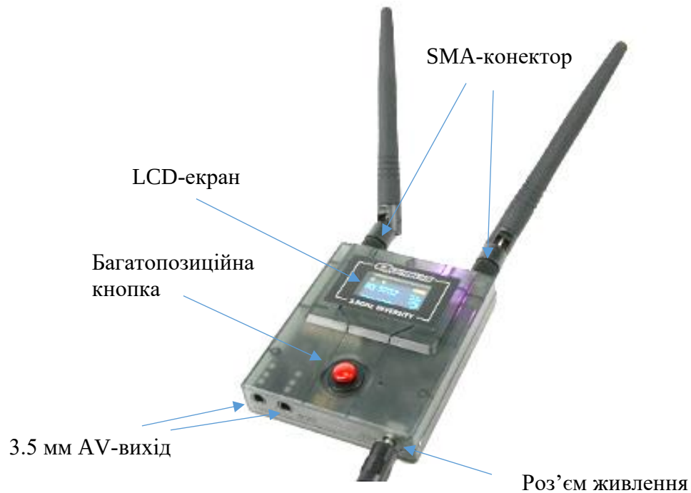
Рисунок 1.2 – Радіоприймальний пристрій сигналів систем Відеопілотування QUANUM RC540R
