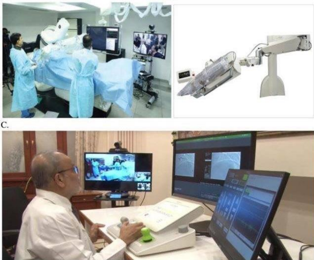
Рисунок 1.2 – Проведення операції через Інтернет на відстані 30 км точним судинним роботом, розрабленим в Corindus [4]
