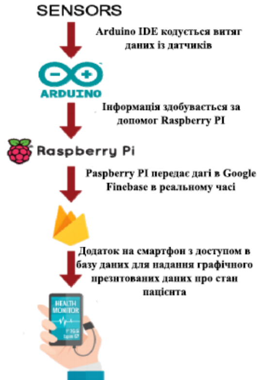
Рисунок 3.7 – Архітектура блоків модулів віддаленої системи моніторингу
