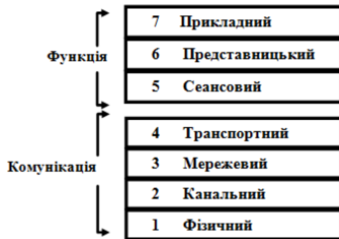
Рисунок 2.3 – Модель взаємодії відкритих систем OSI
