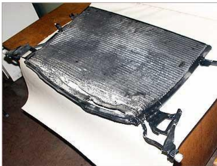
Рис. 2.4. – Радіатор кондиціонера (конденсор) після аварії
