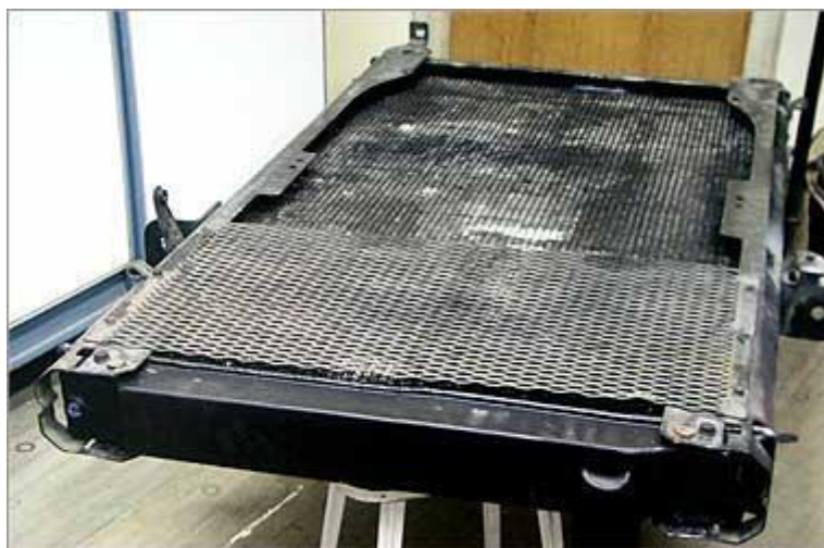
Рис. 2.2. – Той самий радіатор після ремонту
