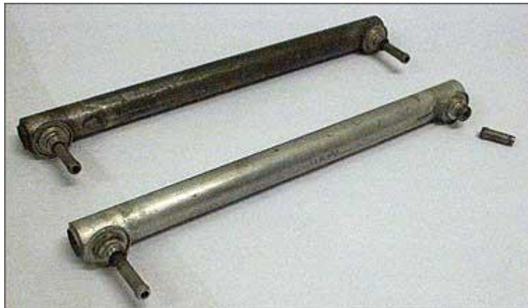
Рис. 2.7. – Несправності бачків із вбудованими масляними радіаторами
