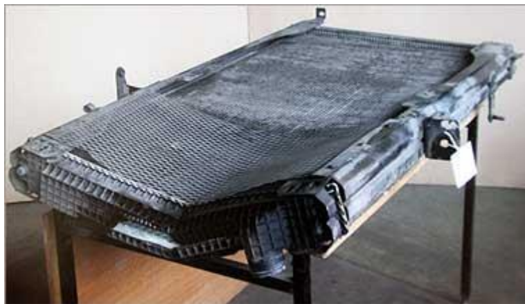
Рис. 2.1. – Радіатор вантажного автомобіля після аварії
