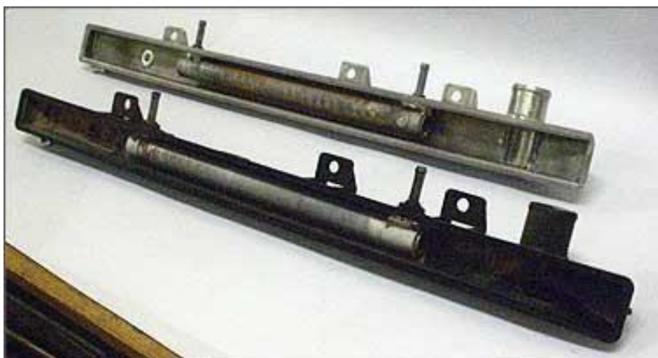
Рис. 2.6. – Приклади масляних радіаторів, вбудованих у бачки системи охолодження
