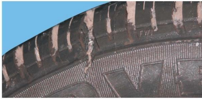
Рисунок 1.1 – Наскрізний проріз шини [13]
