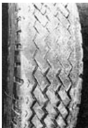
Рисунок 1.9 – Плямисте спрацювання (місцевий знос)
