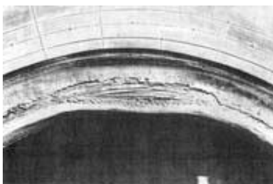
Рисунок 1.19 – Пошкодження борта через несправності обода
