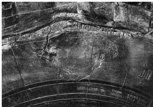
Рисунок 1.14 – Розрив каркаса внаслідок застрягання каміння між подвоєними шинами
