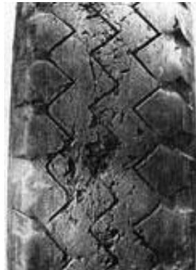
Рисунок 1.10 – Вищерблення поверхні протектора, утворення тріщин, порізів
