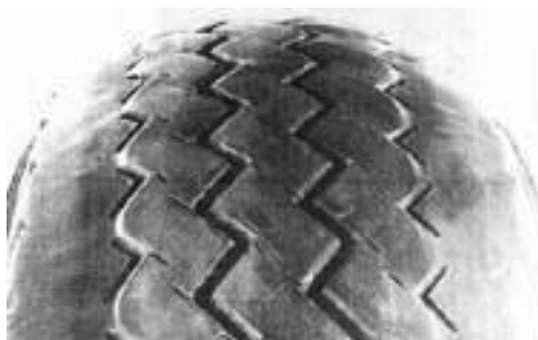
Рисунок 1.3 – Передчасне двостороннє спрацювання в плечовій зоні
