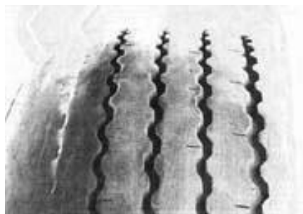
Рисунок 1.2 – Передчасне одностороннє спрацювання в плечовій зоні
