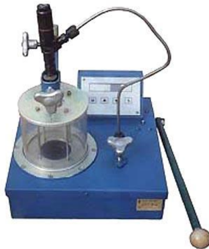
Рис. 2.2 Стенд М-106Е для перевірки дизельних форсунок
