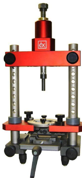
Рис. 3.4 Прес «Джудітта» для розбирання-складання п'єзо форсунок
